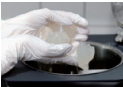
Formherstellung mit dem Dublimat Pro
