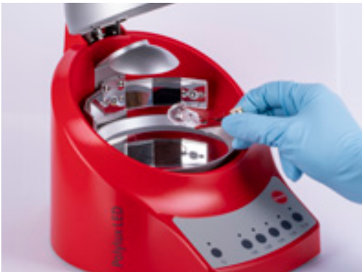
Aushärtung einer lackierten Otoplastik im Polylux LED
