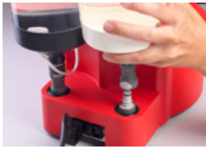
Herstellung einer Form mit dem Dosper evo
