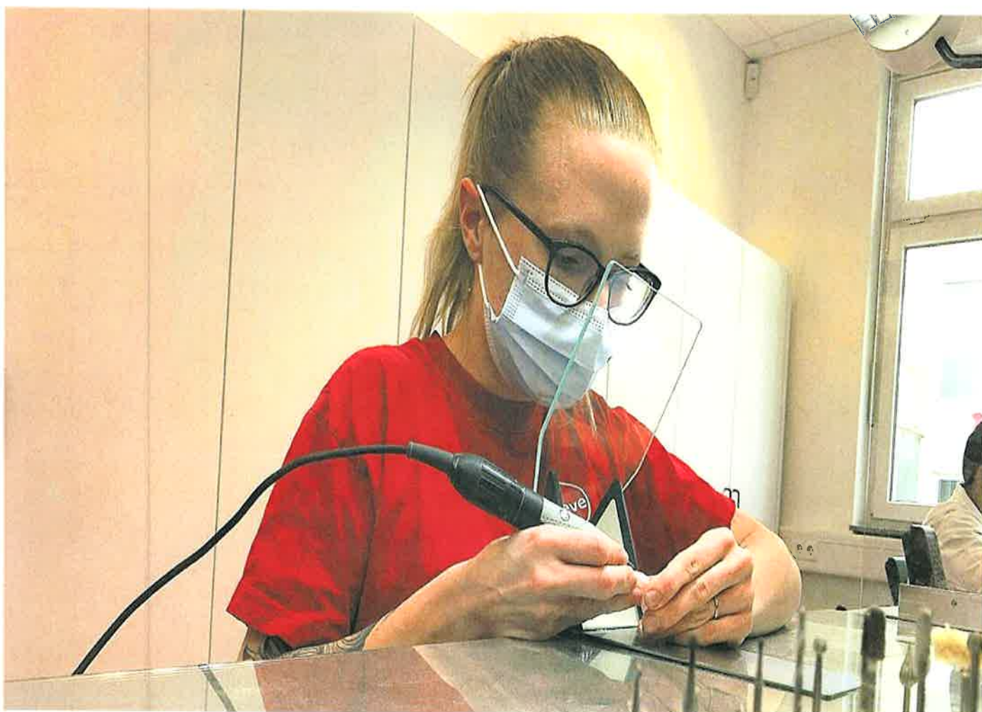
Chantal Haarhoff arbeitet im neuen Otoplastiklabor bei Dreve in Unna. Hier bearbeitet sie einen Rohling aus dem 3D-Drucker.
