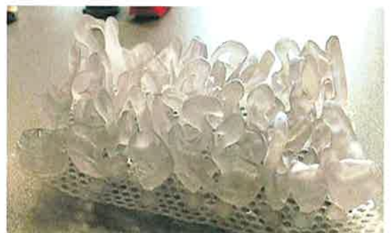
So sehen die Rohlinge aus, wenn sie aus dem 3D-Drucker kommen, jetzt beginnt die Handarbeit.
